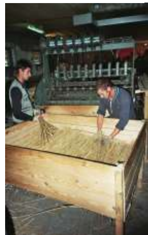
Fertigung von Strohmat- ten im Dorf zum Dach- decken
